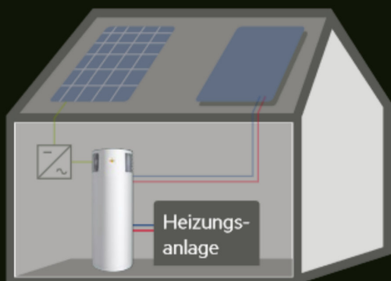
WPT 300 EL Plus, gekoppelt mit Heizungsanlage (+ Photovoltaik optional)
